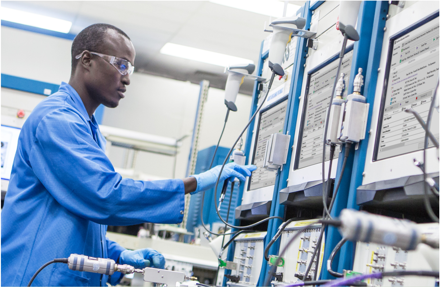
RF 제조용 테스트 시스템에서 TestStand와 함께 사용하는 NI PXI
