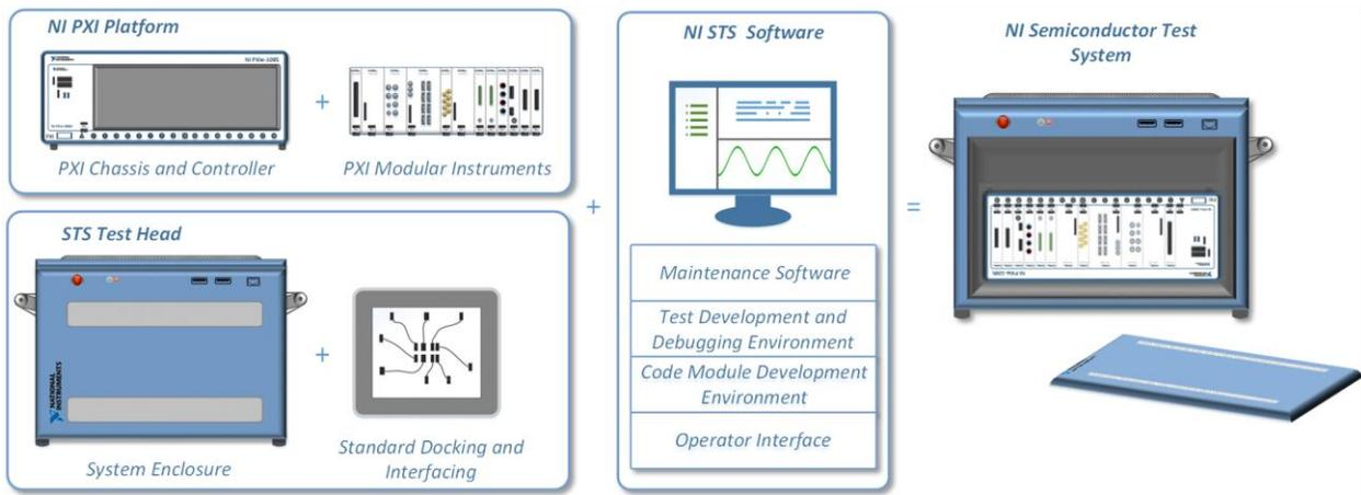
그림 3. STS 는 생산 준비가 완료된 폼 팩터 형태로 실험실용 PXI 계측기 수준의 우수한 측정 범위와 품질을 제공합니다.
